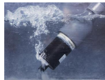
3 raske støt med trykkluft rengjør sensoren. Intervall kan fritt programmeres i transmitteren.
