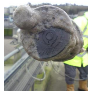
Q-blast systemet holder elektroden ren for slam og belegg.
